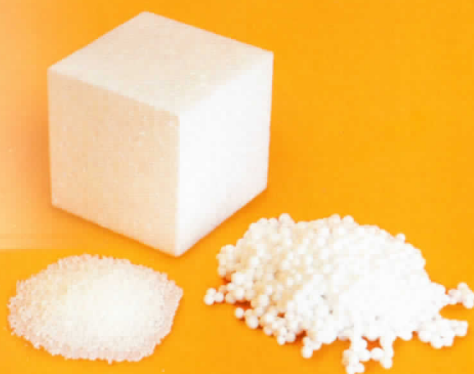
Het productieproces van EPS in een notendop: een granulaat-bolletje expandeert naar een EPS-parel en wordt daarna tot een blokvorm geperst
