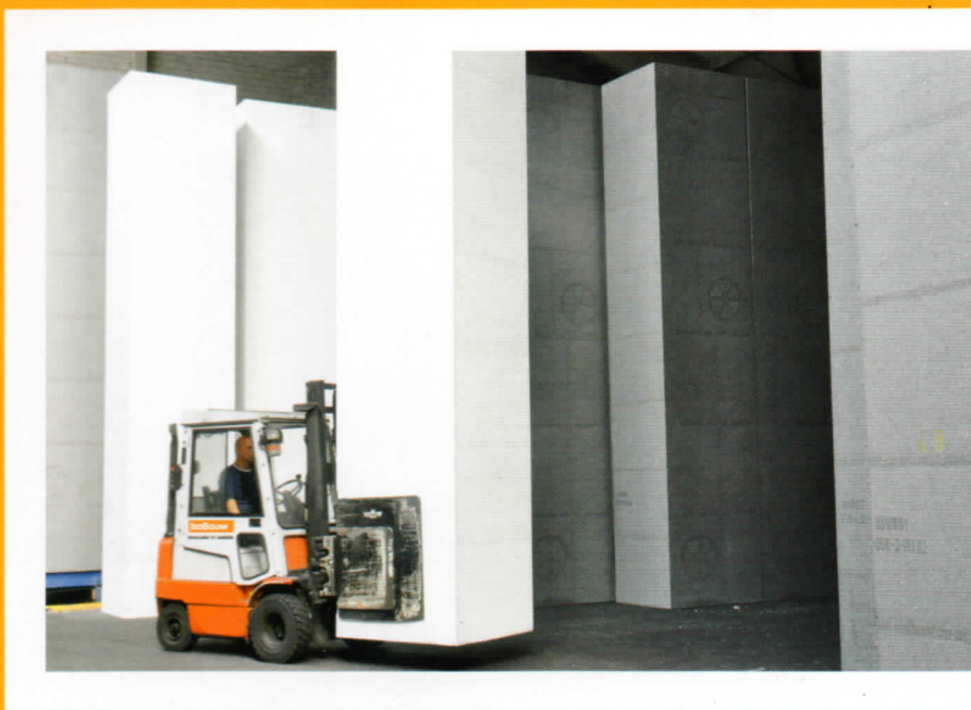
DE EPS-isolatieplaten zijn klaar voor transport
